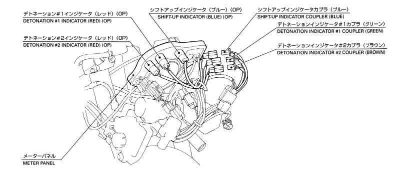
シフトアップ時期を知らせるインジケータと出力付きデトネーションカウン ターを使用した時にカウントアップ時に光るインジケータをOP設定しました。
