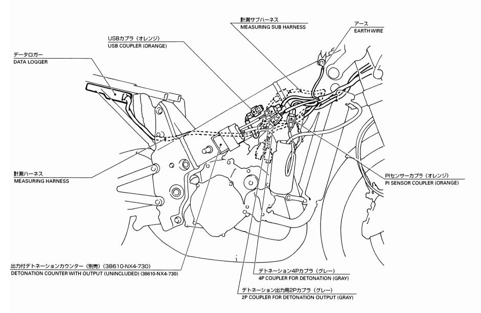
・ロガー本体の取り付け / Installation of the Logger Body
