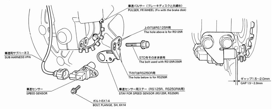
上図の様に、車速センサーをセンサーステーに取り付け、ボルト2本でフロ ントフォークボトムに固定する。その際に、上の穴2つはRS125R用、下の穴2つ はRS250R用として使用して下さい。この穴は車速センサーと車速パルサーのギ ャップを調整できる様に長穴になっていますので、上図の様に1.5mm~2mmに ギャップがなる様に固定して下さい。このギャップが広すぎますとノイズの原 因となりますのでご注意ください。
